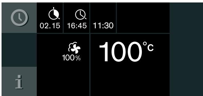
Прибор переходит в режим ожидания. На дисплее отображается режим работы, температура, время приготовления и окончание времени приготовления. Прибор запускается в рассчитанный момент времени и автоматически выключается по окончании времени приготовления.
