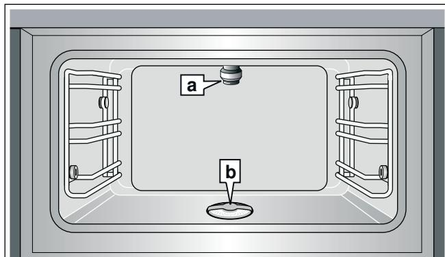
С помощью программы очистки удаляются стойкие загрязнения. Картридж для очистки (a) привинчивается в верхней части рабочей камеры. Рабочая камера очищается, промывается и просушивается автоматически. Сетчатый фильтр (b) во время выполнения программы очистки должен оставаться установленным на дне рабочей камеры.
