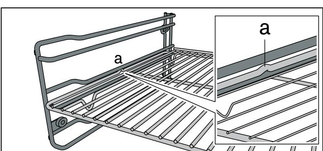
При установке лотка без отверстий следите за тем, чтобы фиксирующий выступ (а) был обращён наверх.
