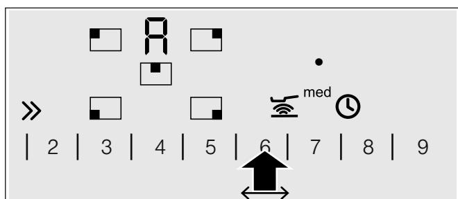
Символ ● горит до тех пор пока не будет достигнута температура жарения. Потом раздается сигнал. Символ температуры гаснет.
